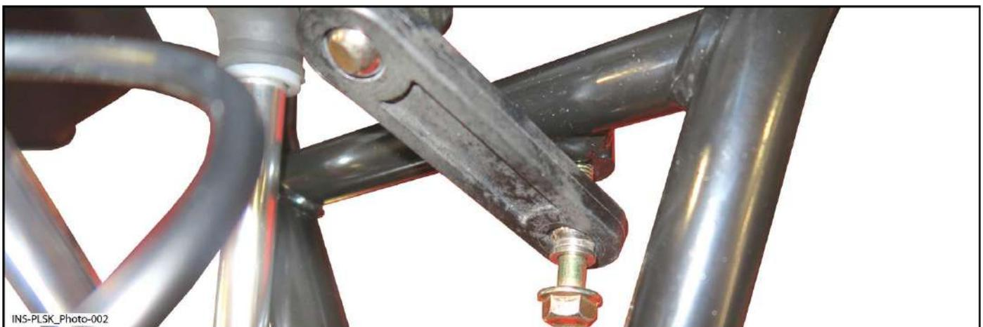
3.3 Retirez et conservez la vis, l'écrou et les rondelles. Commencez par celui du bas pour accéder à l'écrou supérieur. Retirez l'écrou supérieur et retirez les bras de la jambe de ski.
