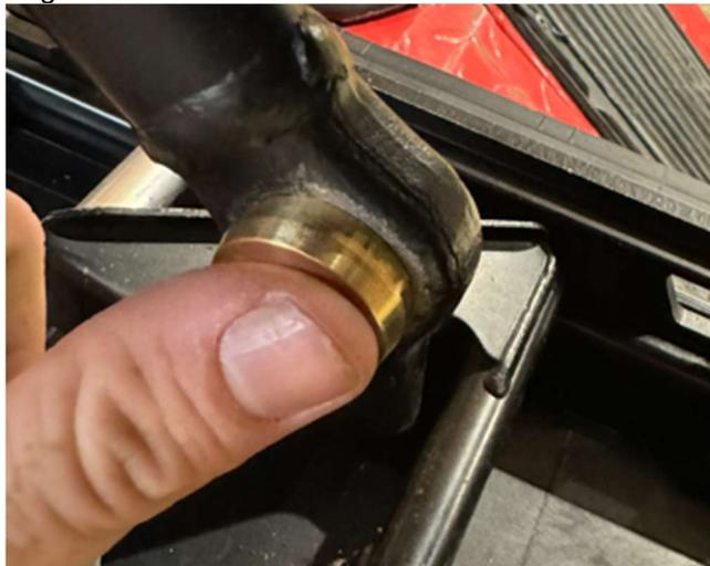
4.7 Une fois la bague de laiton complètement inséré, installer la circlip inclus dans votre trousse. Si la circlip ne s'introduit pas complètement dans la rainure, la bague est probablement pas assez inséré. Répété l'étape 4.6 jusqu'a ce que la bague soit complètement inséré.
