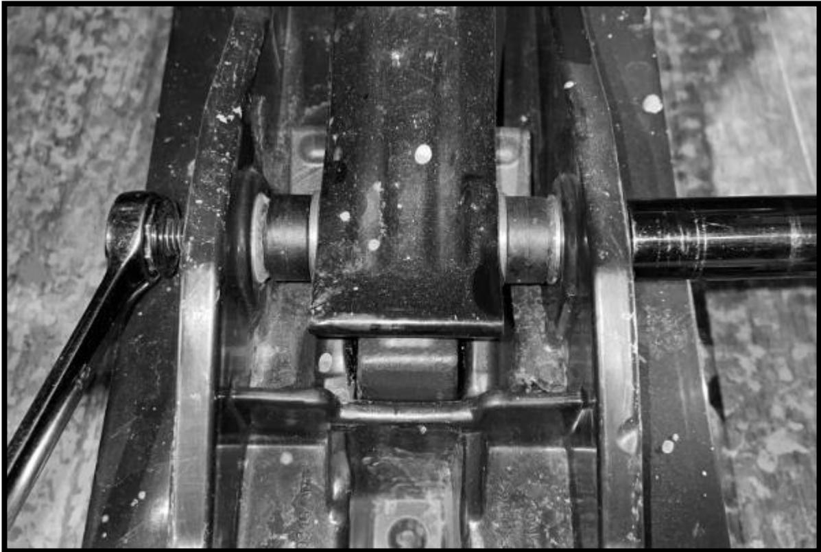
3.1 Répéter les opérations 3.1 et 3.2 pour le deuxième coussinet de ski. N'oubliez pas de serrer les écrous aux spécifications du fabricant.
