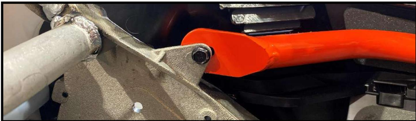
4.4 Fixer le pare-chocs avant G5 [P1] avec quatre (4) rivets 3/16 po [P4] en utilisant une riveteuse manuelle.
