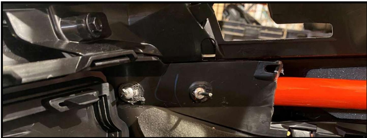
4.6 Mettre en place le support du connecteur de température du silencieux.
