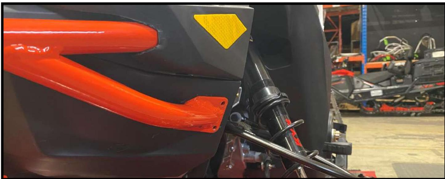
4.5 Fixer le pare-chocs avant G5 [P1] avec quatre (4) rivets 3/16 po [P4] en utilisant une riveteuse manuelle.
