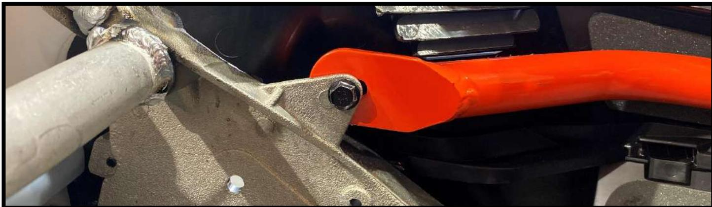
4.4 Positionner le pare-chocs afin d'obtenir un ajustement optimal des plaques latérales avec la carrosserie.
