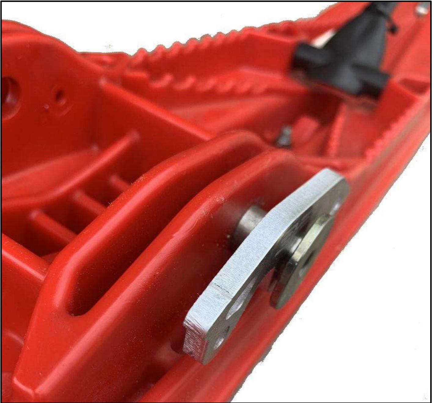
4.4 En se servant des trous du RSG comme gabarit de perçage, percer les 2 trous de fixations à l'aide d'une mèche 1/4". S'assurer de percer les 2 parois du ski, sans bouger le RSG.
