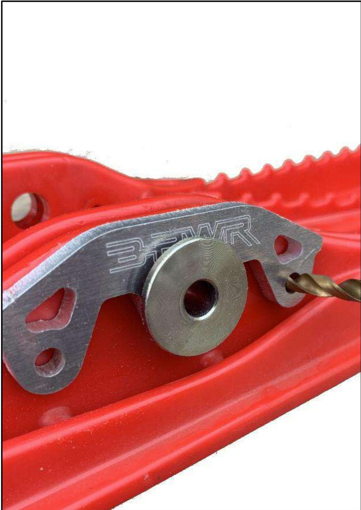
4.5 Insérer le RSG entre les 2 parois du ski, vis-à-vis les trous déjà percer et replacer le coussinet de (l'intérieur vers l'extérieur).
