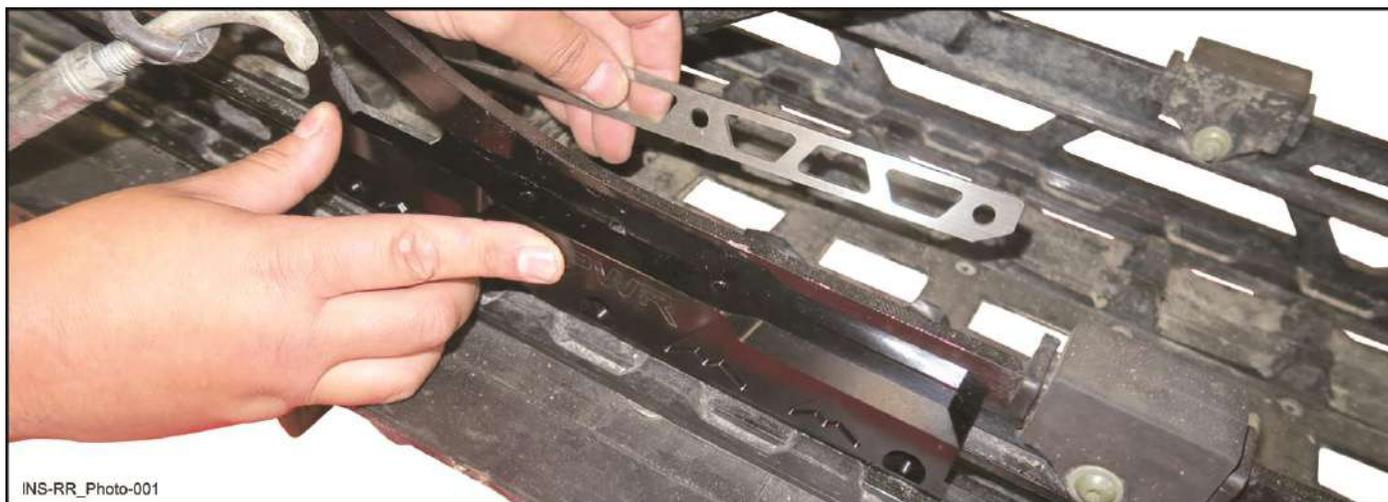
*Note: Si la butée en caoutchouc est en conflit avec le renfort de rail universel [P1], la retirer.*
