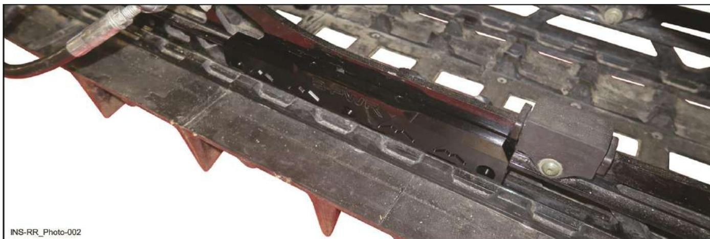
4.3 Installer la butée en caoutchouc [P3] sur le renfort de rail universel [P1] avec des vis hexagonales à épaulement M6 X 16 mm [P6] en utilisant un tournevis cruciforme [T3].
