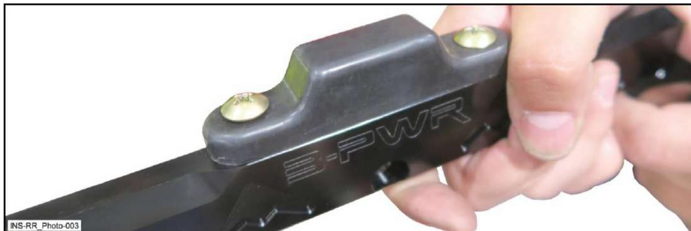
4.4 Installer le renfort de rail universel [P1] avec trois (3) vis hexagonales à épaulement M6 X 20 mm [P2] et écrous autobloquants M6 [P5]. Serrer à la main seulement.
