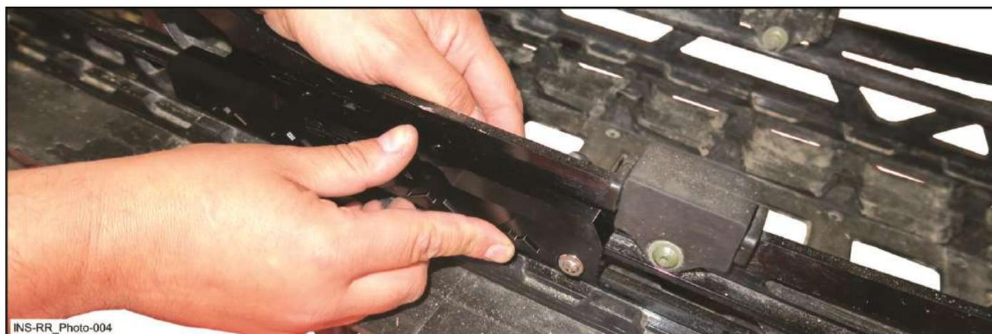
4.5 Fixer le le renfort de rail universel [P1] en utilisant une clé Allen 6 mm [T5] et une clé 19 mm [T2]. Serrer au couple spécifié.
