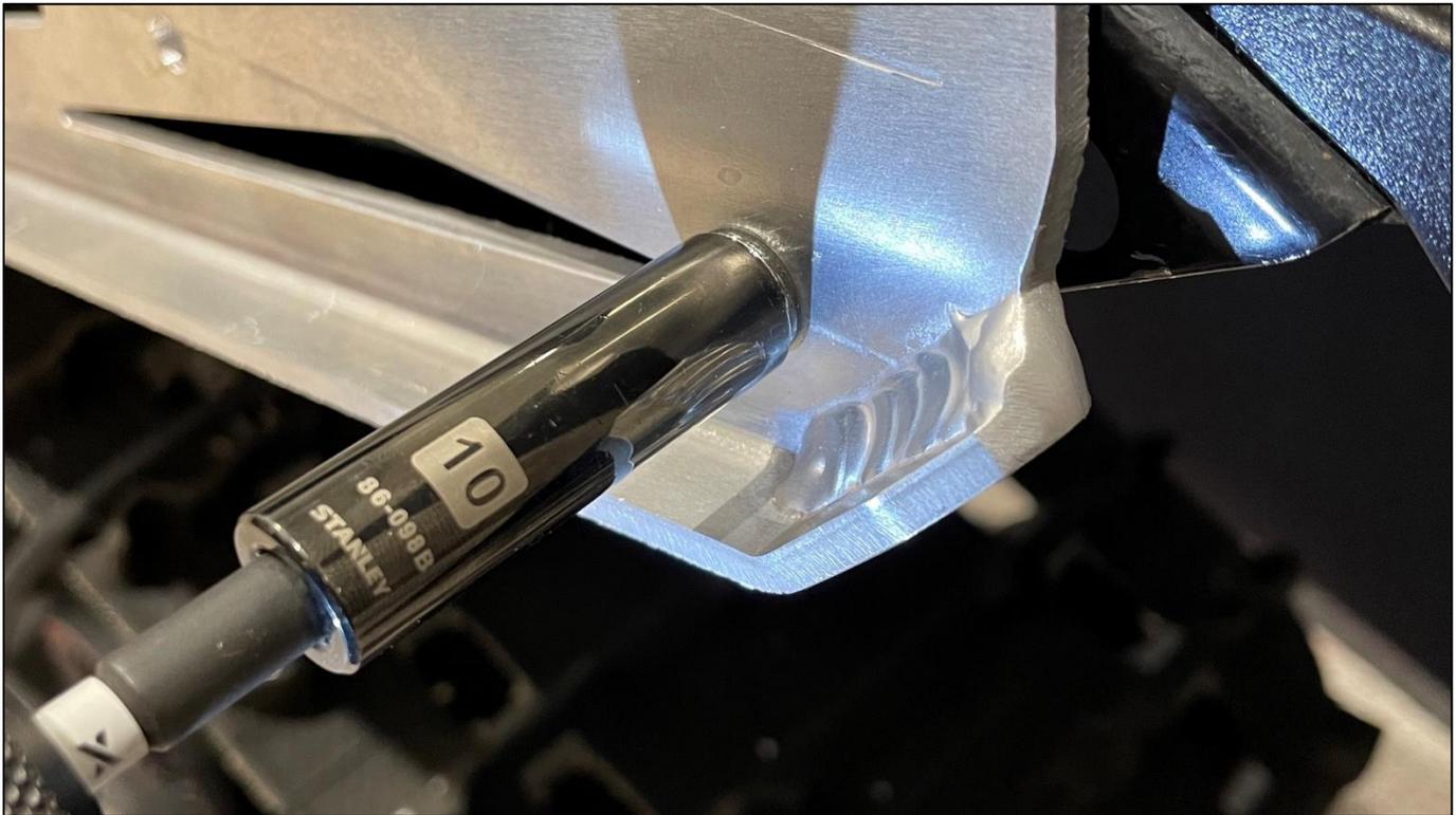
4.6 Percer les trous à l'avant du tunnel en utilisant le pare-chocs comme gabarit et en utilisant un foret 3/16", tel qu'illustré ci-dessous.
