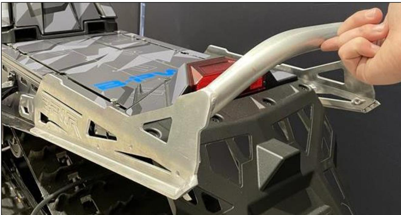
4.4. Positionner le pare-chocs arrière [P1] au moyen de vis à tête hexagonale [P2], rondelles plates [P5] et écrous autobloquants [P3]. Serrer à la main seulement.
