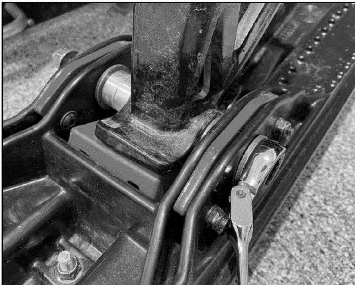
3.3 Répéter les opérations 3.1 et 3.2 pour le deuxième coussinet de ski. N'oubliez pas de serrer les écrous aux spécifications du fabricant.
