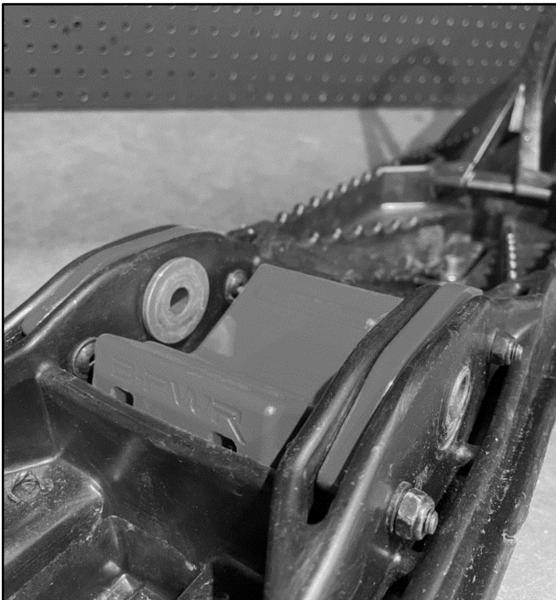
3.2 Réinstaller le ski sur la motoneige. Réutiliser le boulon et l'écrou d'origine dans le montage. Serrer l'écrou aux spécifications du fabricant.
