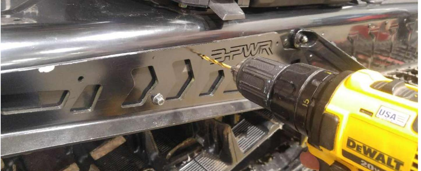
4.5 Fixer l'avant du pare-chocs avec les rivets 3/16 po [P4] dans les trous percés précédemment et en utilisant une riveteuse manuelle.
