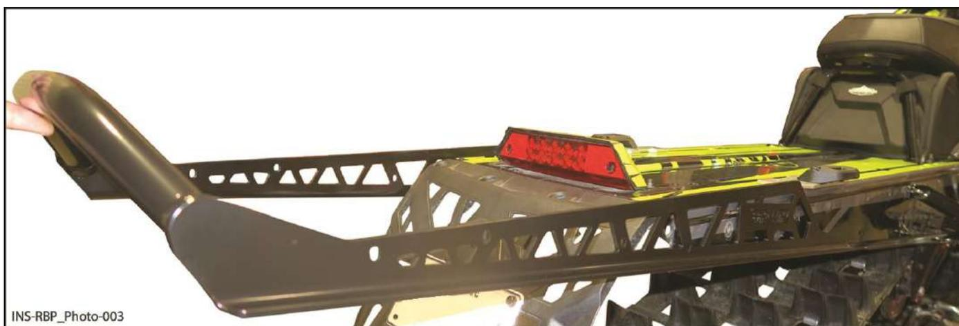
4.2 Positionner le pare-chocs arrière [P1] au moyen de vis à tête bombée Torx T25, M5x20mm [P2] et écrous autobloquants M5 [P3]. Serrer à la main seulement.
