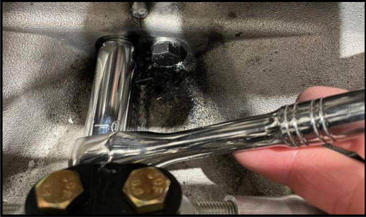
3.6 Remettre l'amortisseur et la barre de torsion en place. Ne pas oublier de remplacer les écrous élastiques OEM par ceux fournis avec vos bras de suspension B-PWR. Voir photo ci-dessous.
