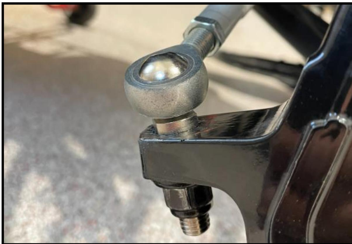
3.13 Serrer maintenant les boulons et écrous aux spécifications du fabricant. **Il est toute fois possible qu'un ajustement d'alignement soit nécessaire sur la motoneige après l'installation des bras de suspension.** Se referer au recommandations du fabricant pour cette étape. L'installation est terminer.
