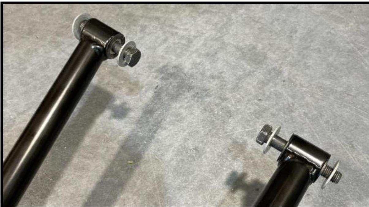
3.8 Installer maintenant le bras supérieur [P3] OU [P4]. sur la motoneige. Ne pas oublier de remplacer les écrous élastiques OEM par ceux fournis avec vos bras de suspension B-PWR. Voir photo ci-dessous.
