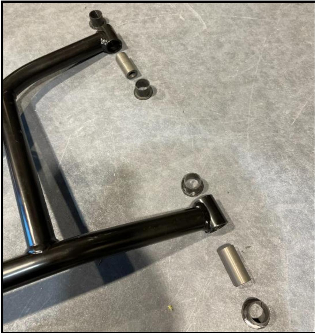
3.3 Une fois les espaceurs installés dans le bras de suspension inférieur [P1] OU [P2], installer maintenant le bras inférieur [P1] OU [P2] sur la machine. Porter une attention spéciale à la plaque d'espacement incluse avec la motoneige. Elle doit être positionnée dans l'axe de la vis. Voir photo ci-dessous.
