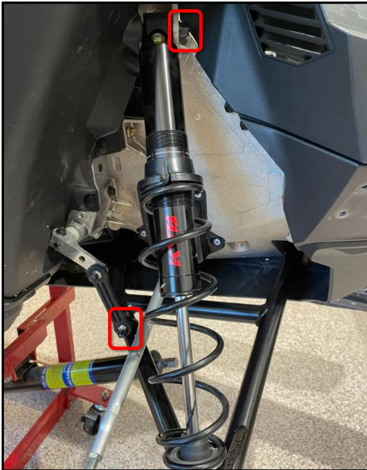
Attention ; lors de l'installation de l'amortisseur, l'ordre d'installation des espaceurs OEM est importante. Vous devez seulement réutiliser un des deux espaceurs d'aluminium OEM lors de l'assemblage de vos bras B-PWR. Voir photo ci-dessous pour valider le positionnement de l'espaceur par rapport à l'amortisseur.
