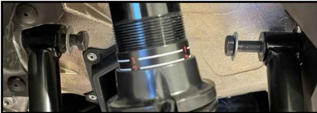
3.9 Serrer maintenant les boulons et écrous aux spécifications du fabricant.
