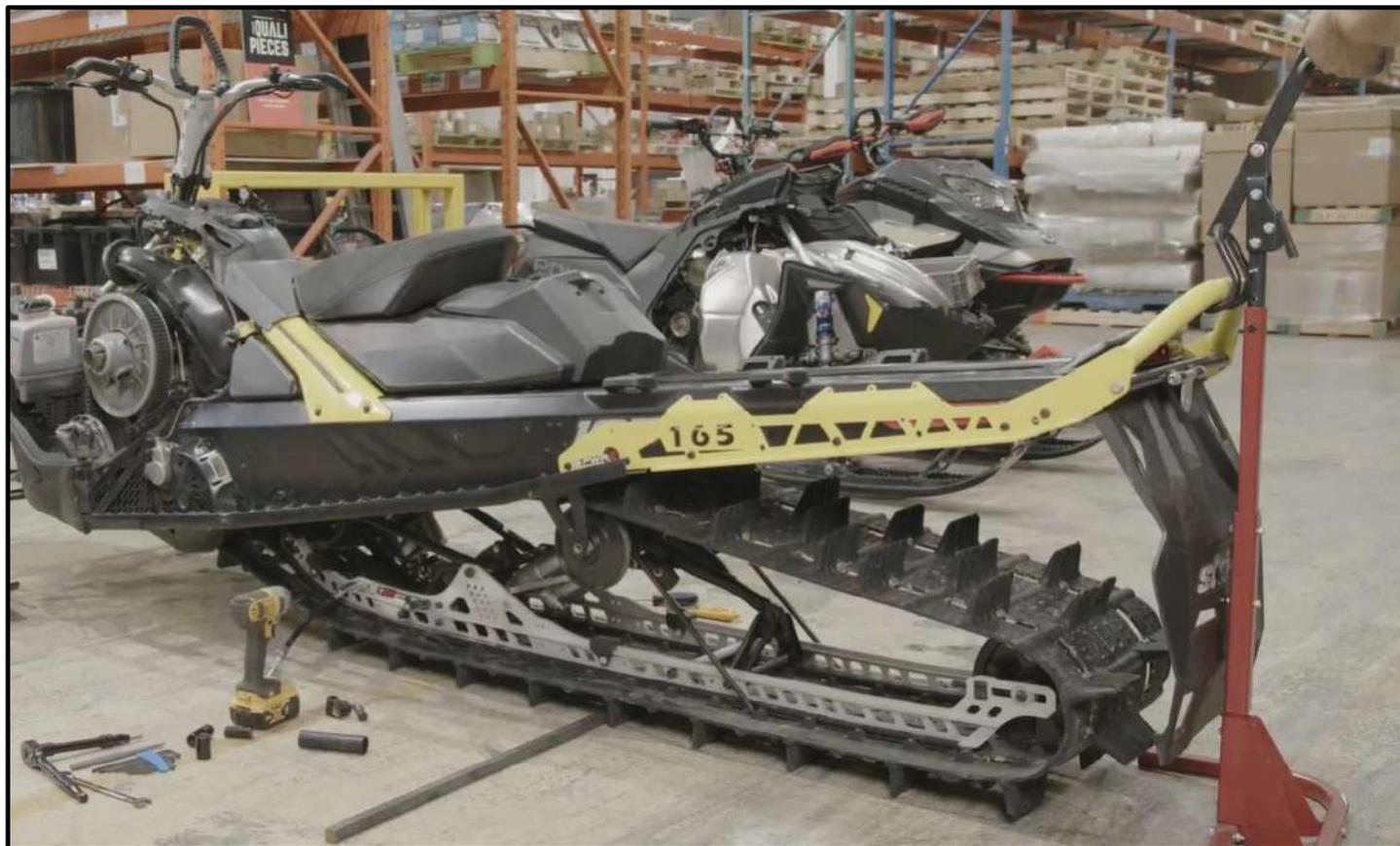
4.6 Ajuster le positionnement à l'aide d'une bar, installer la vis de retient hexagonal (Voir manuel du fabricant pour le coupe de serrage).
