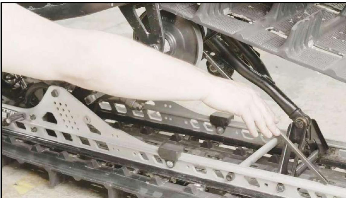
4.3 Dévisser la vis hexagonal et la petite vis à 6 pan creux pour enlever l'espaceur et la roue.
