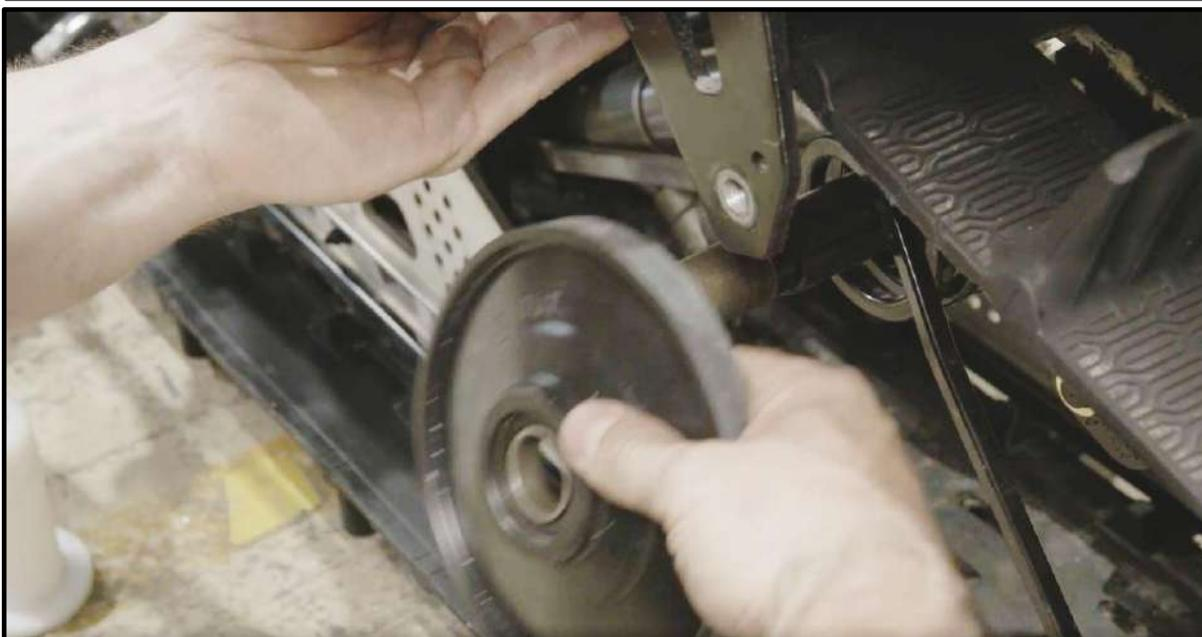
4.4 Utiliser un couteau pour retirer le plastique collé sur l'arbre, entrer la bague de ressort.
