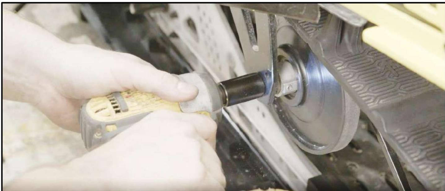
4.7 Remonter le derrière de la motoneige, remettre le ressort vers l'avant (en tension) et remettre le support de ressort avec les vis à 6 pan creux. (Voir manuel du fabricant pour le coupe de serrage).
