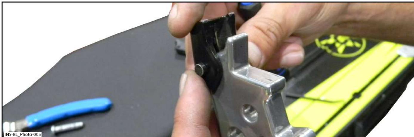
5.2 Fixer le support de frein sur le levier [P1] avec un écrou à pression.
