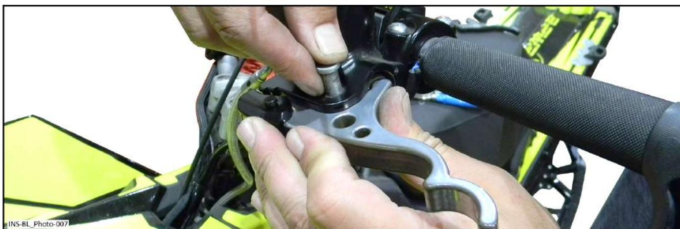
5.4 Fixer le levier de frein en aluminium [P1] en insérant le circlip dans la rainure de la goupille d'assemblage en utilisant une pince à circlip [T2] tel qu'illustré.
