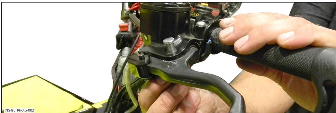
4.3 Enlever et conserver l'écrou à pression et la goupille d'assemblage retenant le support de frein en utilisant un tournevis plat [T1].
