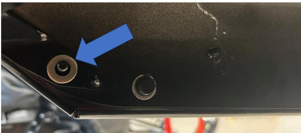
4.5 Insérer la plaque de support latérale [P1] sur les vis [P2]. Insérer les écrous [P3] sur les vis [P2]. Serrer au couple spécifié.
