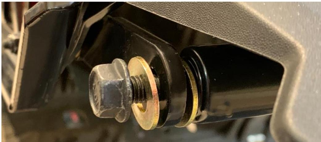
4.9. Positionner le tube à l'horizontal et serrer au couple de serrage spécifié.
