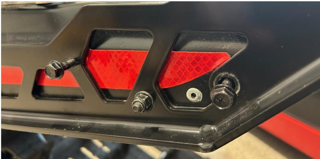
4.4 À l'intérieur du tunnel, insérer la rondelle [P6] sur la vis [P2] la plus en arrière du tunnel.
