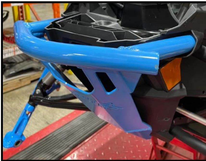
4.8 Installer les quatre vis épaulement à tête hexagonale M6 x 1.0 x 16mm [P4]. Attendez que les quatre vis soient bien engagées avant de les serrer.
