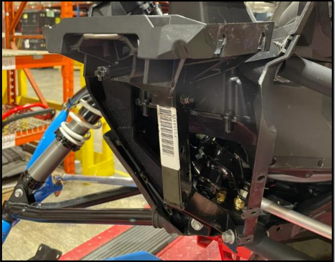
4.2 Une fois la plaque protectrice retirée, insérer une rondelle [P8] dans chaque plaque de renfort. Faire le pré-montage du boulon avec la séquence de rondelle démontrée dans la photo ci-dessous. (Voir photo ci-dessous pour plus de détails).
